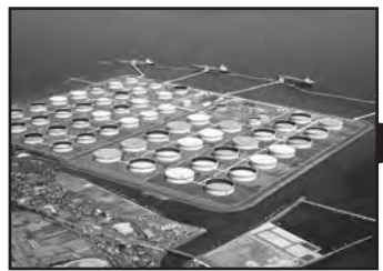
タンカーから原油をおろすときの安全性を考え、沖合にさん橋がつくられています。
