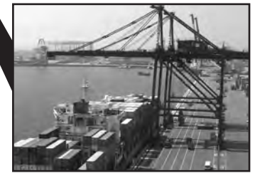
コンテナを積みおろすための大きなガントリークレーンがあり、コンピューターで管理されています。
